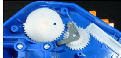
④ クランクギア部(灰色)とギアA間のグリスだけを除去すれば良いのですが、他の箇所から飛び火する可能性が有る為、全グリスを除去しました。治療後に組み上げてボタン連打による動作確認をしました。正常にリフトは上昇しました。
